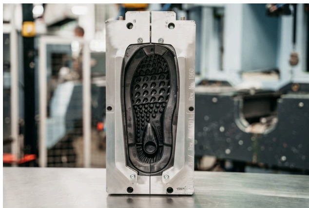
Рис. 2 Индивидуализированная фотополимерная вставка в обувную пресс-форму (BUSINESS WIRE)
