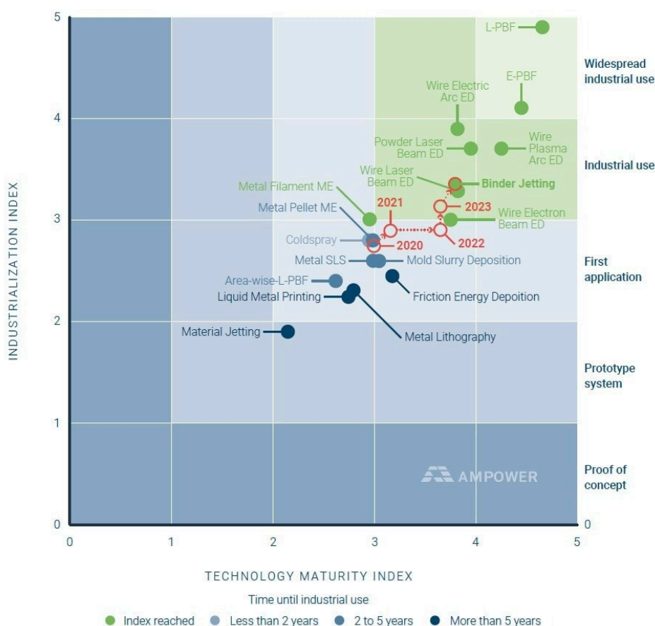
Рис. 6 Диаграмма технологической зрелости АТ по металлу (Ampower, 2024)
