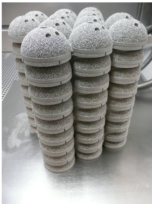
Рис. 4 Производство ацетабулярных чаш по технологии ЭЛП (GE)
