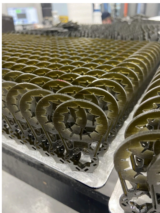
Рис. 3 Серийное производство кронштейнов для крепления смесительной насадки (Merit3D)
