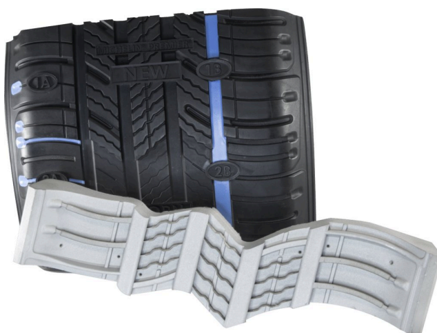
Рис. 5 Пресс-форма с ламелями и готовая шинная продукция (AddUp)
