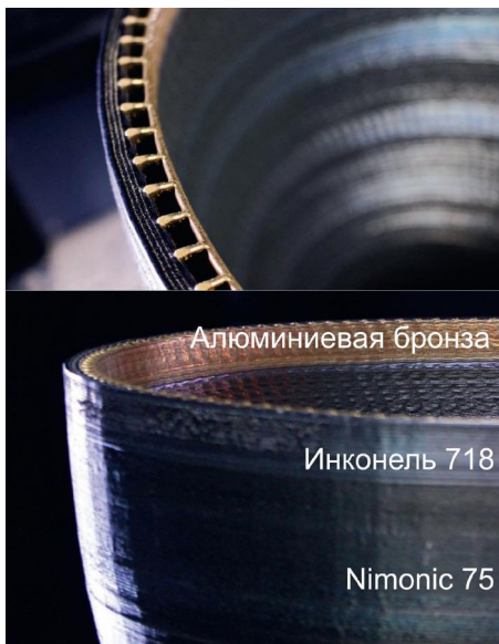
Рис. 3. Полиметаллическое ракетное сопло, напечатанное по технологии DMT/DED-P (фото: Insstek, Корея)
