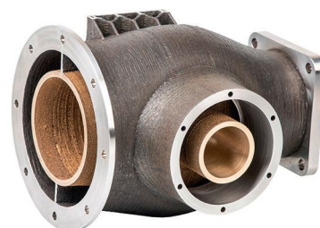
Рис. 4. Возможности гибридной обработки ММ двухканального теплообменника из меди (внутренняя часть) и алюминия (внешняя часть) на станке LASERTEC 3D (фото: DMG MORI, Германия)
